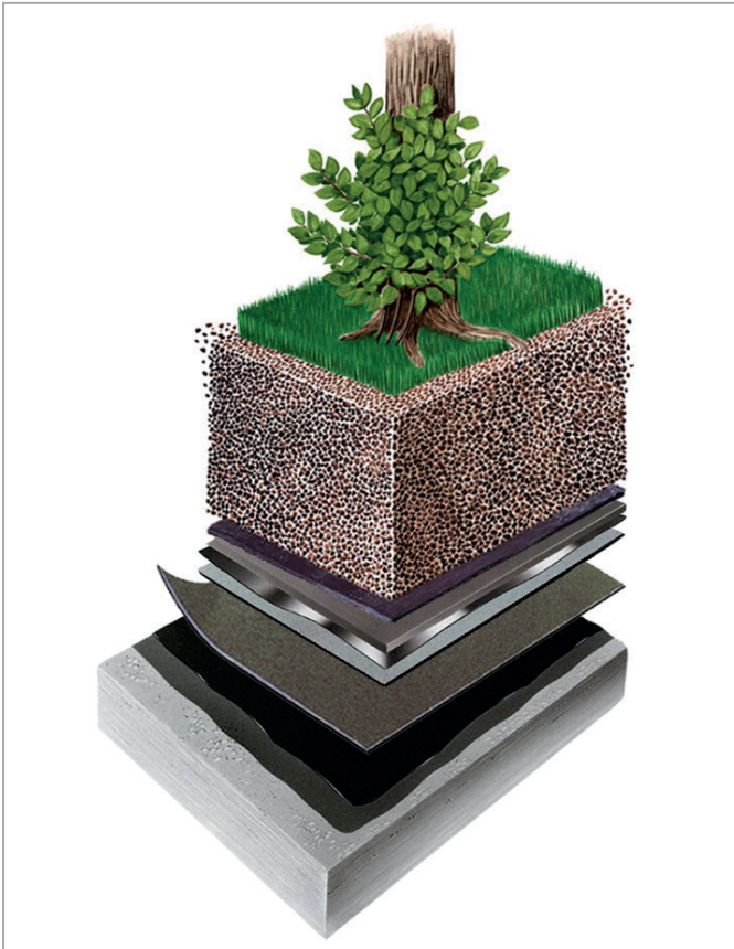
Der zum Einsatz gekommene Abdichtungsaufbau mit einer durchwurzelungsfesten Oberlagsbahn machte eine intensive Begrünung des Parkdecks möglich.
