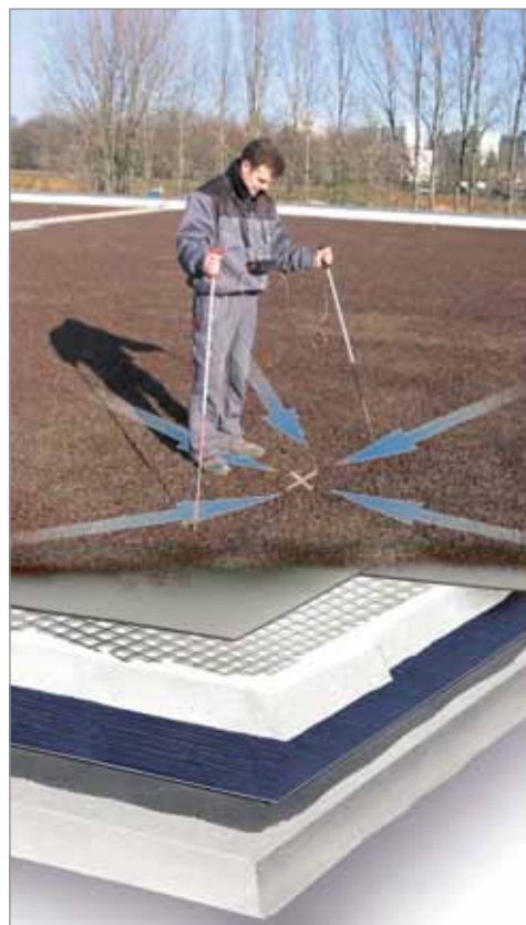
Nach Beendigung der Bauarbeiten wird die Dichtigkeit von unserem Servicepartner ILD überprüft. Der Bauherr erhält ein dichtes Dach mit Brief und Siegel.
