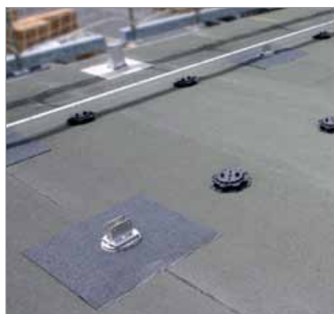
Kernstück der VEDASOL Fix-Konsole ist eine 40 x 40 cm große Edelstahlplatte für eine hohe Lastverteilung bei geringem Eigengewicht.
